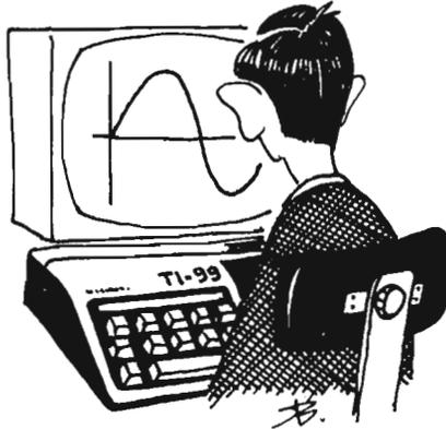
Al termine della prima operazione il computer avrà memorizzato, per ogni pix-colonna, il numero di pix-riga corrispondente al valore della funzione. Dovrà poi colmare tutte le lacune eventualmente esistenti tra ogni punto ed il successivo, mettendo in ON tutti i pixel tra essi compresi.
